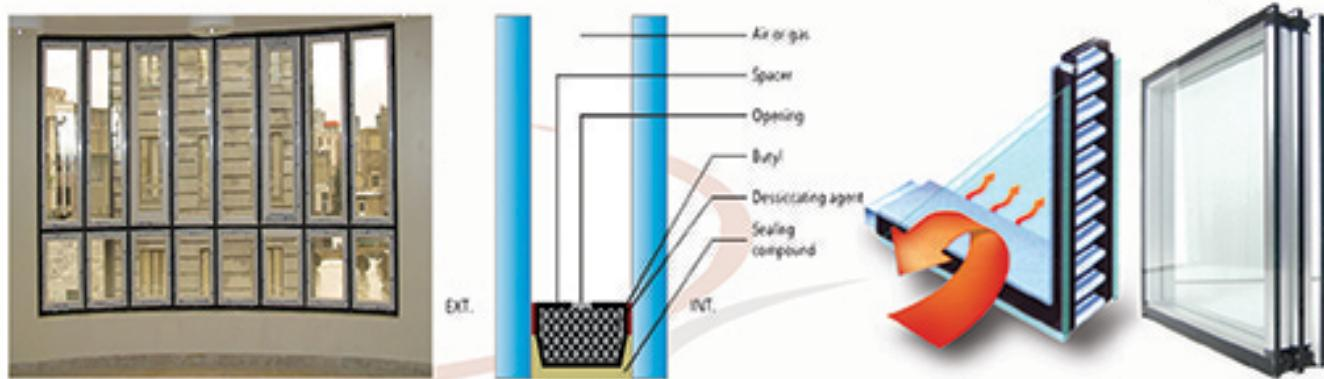
در شیشه دوجداره غالباً از اسپیسرهای آلومینیوم استفاده می شود که درون اسپیسر را با ماده رطوبت گیر پر می کنند، این ماده سبب جذب رطوبت هوای مابین شیشه ها می گردد و توسط مواد درزگیر مناسب، کاملاً آب بندی شده است. اسپیسرهای مورد استفاده در شیشه دوجداره در ضخامت های مختلف ۶,۸,۱۰,۱۲,۱۴,۱۶ میلی متر موجود می باشد. در تهیه شیشه های دوجداره، بسته به نیاز و سلیقه می توان از انواع شیشه های معمولی، رنگی، رفلکس، ملینت و سکوریت استفاده کرد.
